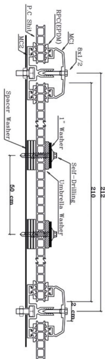
استفاده از پوشش پلی کربنات به جهت استقامت بالا و تبادل حرارتی پایین آن عمدتاً در دیواره های جانبی گلخانه ها استفاده می شود.
